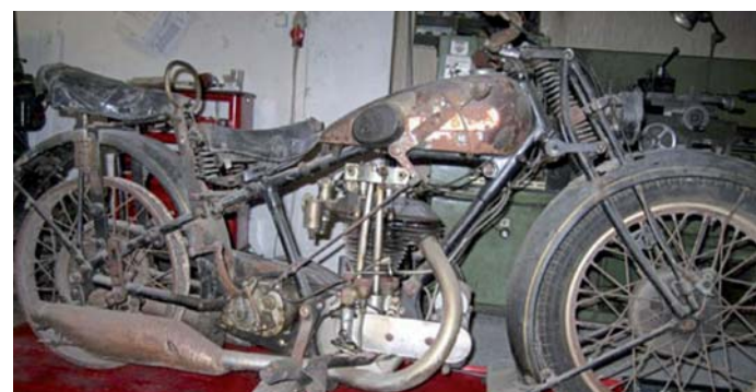
Note 5: Verschlissene Basis, Neuaufbau aller Bauteile nötig
